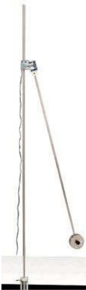
Pendule droit à capteur de mouvement électromagnétique
