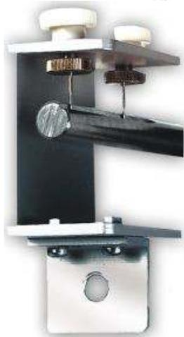
suspension à pivot à faible friction du pendule droit
