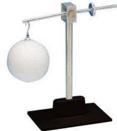
Baroscope à boule à tester
